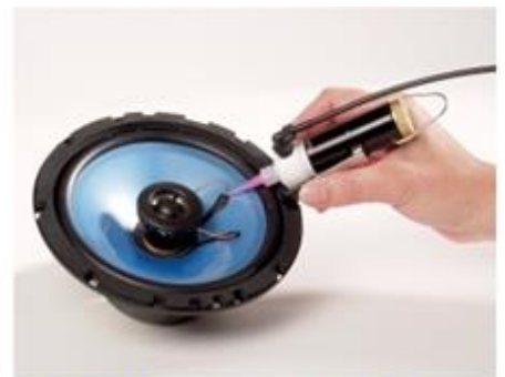
799959.HHHT - Lautsprecher kleben 799959.HHHT - speaker bonding
