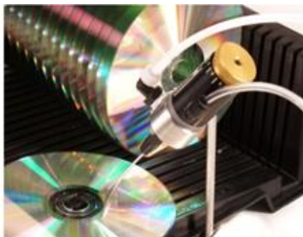
799959.VD - DVD Rotationsbeschichtung 799959.VD - DVD spin coating
