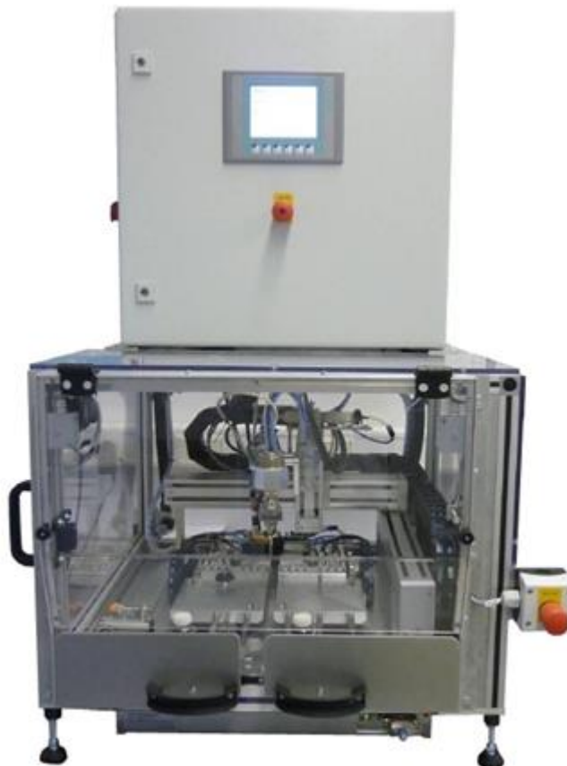
4-Achs-Dosierroboter mit zwei Schubladen für Bauteile 4-axis dispensing robotic system with two drawers
